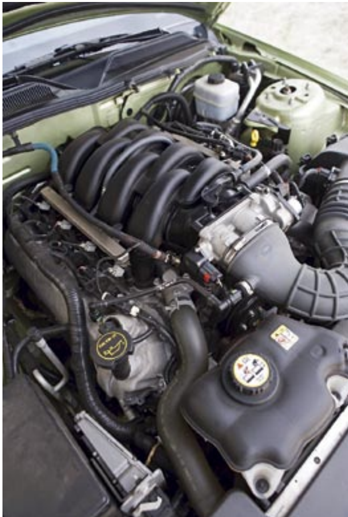
ENKELT VAL. V8-motorn är, vid sidan om bilens linjer, Mustangens största behållning. Ford har trollat fram 300 hästar ur 4,6 liter volym, med ett vridmoment på 320 Nm. Det räcker!
